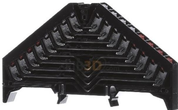
Courant nominal In 8 A, Tension nominale 250 V, Nombre d'étages 8, Nombre de bornes par étage 4, Type d'installation Rail DIN TH35, Matériau du corps isolant Thermoplastique, Température de service -50..130 °C, Largeur 9,2 mm, Hauteur 120 mm, Profondeur 65,5 mm, Version antidéflagrante "Ex e non, Plaque d'extrémité nécessaire oui, Couleur noir, Étages pontés en interne non
