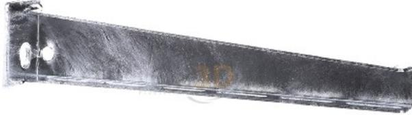
Longueur 310 mm, Largeur 50 mm, Hauteur 65 mm, Convient pour largeur du système de support de câbles 50..300 mm, Version Équerre de fixation latérale et murale, Angle 90 °, Capacité de charge 2,5 kN, Convient pour maintenance des fonctions oui, Matériau Acier, Qualité de matériau divers, Protection de surface galvanisé à chaud
