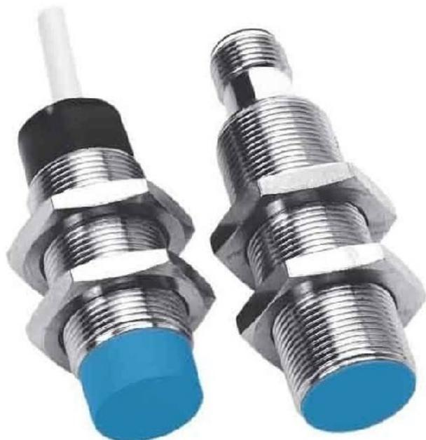
**Capteur,ind.,câble 2m DC,pnp,sn=5,b - Capteur de proximité inductif 5mm IM 18-05B PS-ZW1**
