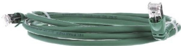
Type de câble S/FTP, Catégorie 6A (IEC), Longueur 2 m, Type de connecteur port 1 RJ45 8(8), Type de connecteur port 2 RJ45 8(8), Couleur de la gaine vert, Manchon antifiambage moulé, Protection par levier à cran oui, Couleur du manchon antifiambage vert, Version ignifuge oui, Sans halogène oui, Résistant à l'huile selon EN 60811-404 non, Construction de câble 4x2, Section transversale AWG 27, Affectation des broches 1:1
