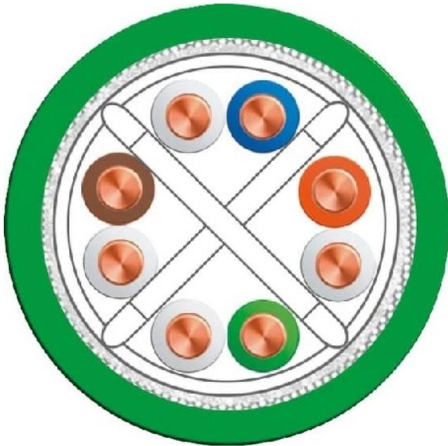
**IE Stand.Cable 4x2 Cat.6 F.Anschl.an FC RJ45 - Cable de données CAT6 8x0,64mm 6XV1870-2E**
