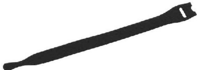
Largeur de la bande 13 mm, Longueur de bande 200 mm, Épaisseur de bande 1,4 mm, Puissance de retenue min. 120 N, Version Bande velcro, Fermeture de bride Fermeture velcro, Matériau Plastique, Qualité de matériau divers, Protection de surface divers, Résistant aux UV selon ASTM D6779 oui, Sans halogène oui, Couleur noir, Transparent non, Fluorescent non, Surface d'étiquetage sans, Fermeture détachable oui, Type de fixation sans, Autorisation VG non, Autorisation MIL non, Autorisation UL non
