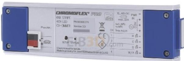
Système de bus KNX oui, Système de bus radio KNX non, Système de bus bus radio non, Système de bus LON non, Système de bus Powernet non, Autres systèmes de bus sans, Type d'installation Montage en saillie, Avec couplage de bus oui, Fonctionnement sur site/manuel non, Avec écran LED non, Interface 1-10 V non, Courant de commutation max. (charge résistive) 2,2 A, Capacité de commutation max. 424 W, Nombre de sorties 4, Degré de protection (IP) IP20
