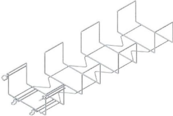
Hauteur chemins de câbles en treillis 105 mm, Largeur chemins de câbles en treillis 300 mm, Diamètre de fil 3,9 mm, Angle 90°, Version sans connecteur, Convient pour maintenance des fonctions non, Matériau Acier, Acier inoxydable, décapé non, Qualité de matériau divers
