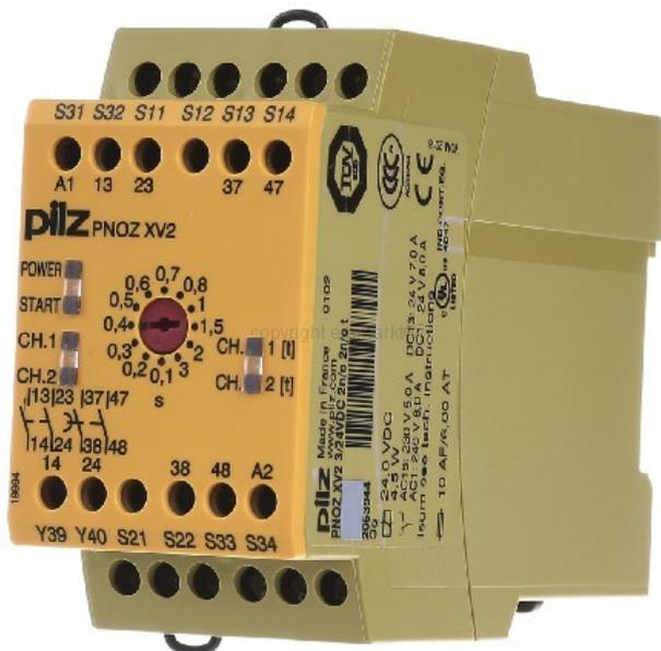
**Commutateur d'arrêt d'urgence 3/24VDC 2n/o 2n/o -
