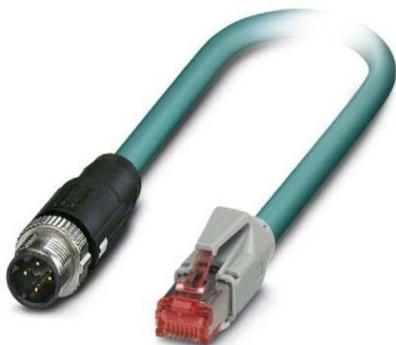
Nombre de pôles 4, Type de contact à fiche, côté champ Mâle (prise), Disposition du câblage, côté site divers, Longueur de câble 5 m, Matériau de la gaine de câble divers, Sans halogène non, Couleur de la gaine du câble divers, Avec écran LED non, Blindé oui, Type de câble multi-fil, Matériel du corps de contact divers, Courant nominal In 1 A, Tension nominale 48 V, Degré de protection (IP) IP65
