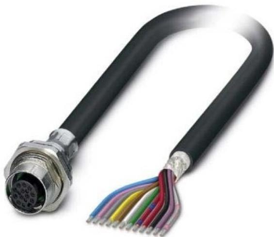
Version des contacts divers, Nombre de contacts de commande 12, Conception du boîtier droit, Courant nominal In 1,5 A, Température ambiante 85 °C, Tension nominale 30 V, Catégorie de surtension II, Degré de pollution 3, Matériau du revêtement de contact Or, Matériau du boîtier divers, Matériau de bague fileté divers, Type de serrure divers, Avec conducteur de protection non, Degré de protection (IP), monté IP65/IP67, Nombre min. de cycles d'accouplement 100, Blindé oui, Avec affichage d'état non
