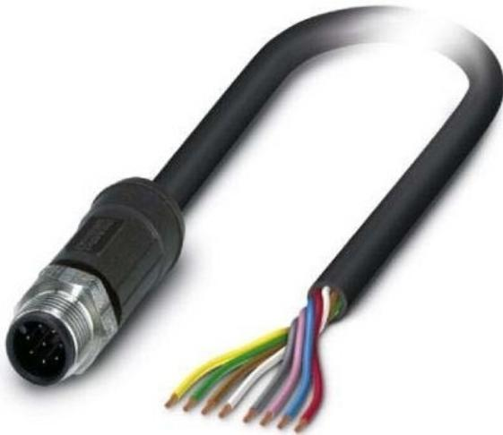
Nombre de pôles 8, Disposition du câblage, côté site divers, Longueur de câble 5 m, Matériau de la gaine de câble divers, Sans halogène non, Couleur de la gaine du câble noir, Avec écran LED non, Blindé non, Type de câble multi-fil, Réticulé non, Matériel du corps de contact CuSn, Matériau du revêtement de contact Nickel/Or, Courant nominal In 2 A, Tension nominale 30 V, Résistance de contact 5000 mOhm, Degré de protection (IP) IP65
