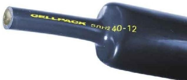
Type Thermorétractable, Version à paroi moyenne, Taux de rétrécissement 3:1, Diamètre intérieur avant rétrécissement 40 mm, Diamètre intérieur après rétrécissement 12 mm, Diamètre nominal en pouces divers, Épaisseur de paroi après rétrécissement 2,6 mm, Longueur 1 m, Température de service -40..120 °C, Couleur noir, Transparent non, Matériau Polyoléfines (PO-X), Sans halogène oui, Avec adhésif intérieur oui, Imprimable oui, Autorisation UL non
