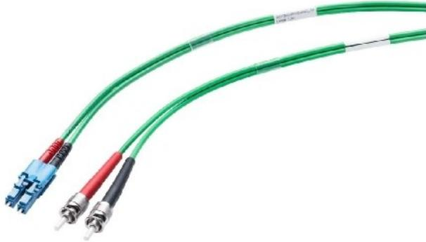
Type de fibre Multimode 50/125, Catégorie OM2, Nombre de fibres 2, Longueur 1 m, Type de connecteur port 1 LC Duplex, Type de connecteur port 2 ST, Couleur de la gaine divers, Convient pour les chaînes porte-câbles non, Degré de protection (IP) IP20
