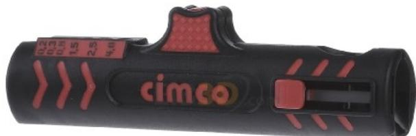
Diamètre zone de dénudage 8..13 mm, Section zone de dénudage 0,2..4 mm<sup>2</sup>, Profondeur encoche réglable oui, Coupe longitudinale oui, Coupe ronde oui, Coupe en spirale non, Couteaux interchangeables non
