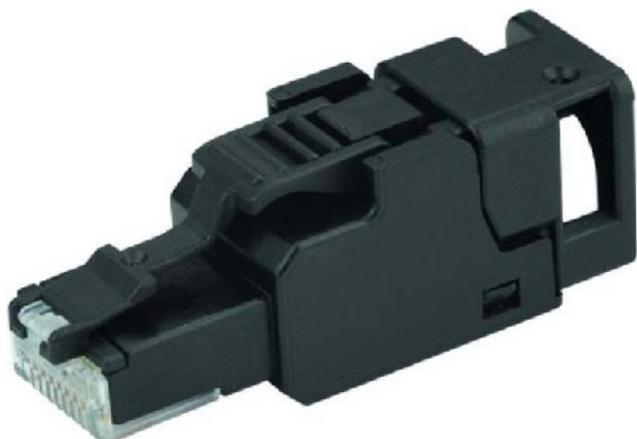
Version Connecteur, Type de connecteur divers, Blindé non, Catégorie 6A (IEC), Type de connexion divers, Outil spécial nécessaire oui, Convient pour câbles ronds oui, Convient pour câbles plats non, Convient pour conducteur toronné oui, Convient pour conducteurs solides oui, Couleur noir, Zone AWG 27..23
