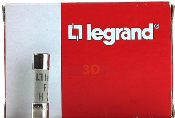
Version Fusible céramique, Taille 5x20 mm, Type de tension CA, Courant nominal 2 A, Tension nominale 250 V, Classe de fonctionnement divers, Fréquence de fonctionnement 50..60 Hz, Version voyant divers, Caractéristique de déclenchement H, Puissance de coupure 1,5 kA, Puissance dissipée au courant nominal 1,4 W
