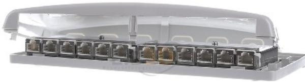
Nombre de bus/couplages 12, Convient pour le nombre de prises/couplages 12, Type de connecteur RJ45 8(8), Blindé oui, Catégorie 6A (IEC), Type de connexion LSA, Nombre d'unités de hauteur 1, Couleur gris clair, Numéro RAL 7035, Type d'installation Montage mural, Hauteur 37 mm, Largeur 255 mm, Profondeur 118 mm
