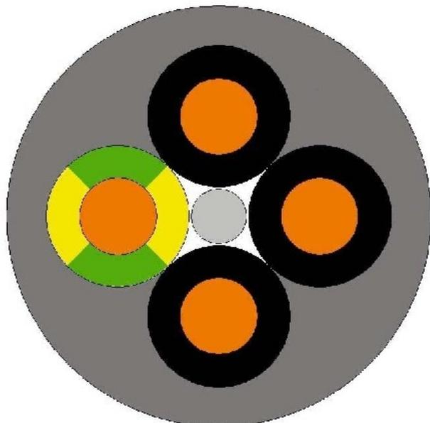
**OELFLEX CLASSIQUE 110 4G1 - Cable de contrôle
