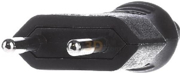
Version divers, Matériau Plastique, Qualité de matériau Thermoplastique, Direction d'enfichage droit, Technique de raccordement Borne à vis, Couleur noir, Nombre de pôles 2, Tension nominale 250 V, Courant nominal 2,5 A, Pour "conditions difficiles" (selon VDE) non
