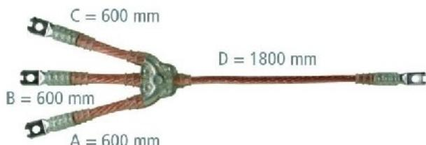
Version Câble, Nombre de pôles 3, Courant de court-circuit max. 19,5 kA, Section transversale de câble côté phase 70 mm<sup>2</sup>, Section transversale de câble côté terre 35 mm<sup>2</sup>, Longueur du câble de phase a 600 mm, Longueur du câble de phase b 600 mm, Longueur du câble de phase c 600 mm, Longueur câble de mise à la terre 1800 mm, Pièce de connexion côté phase sans, Pièce de connexion côté terre sans, Entièrement isolé non, Matériau Cuivre
